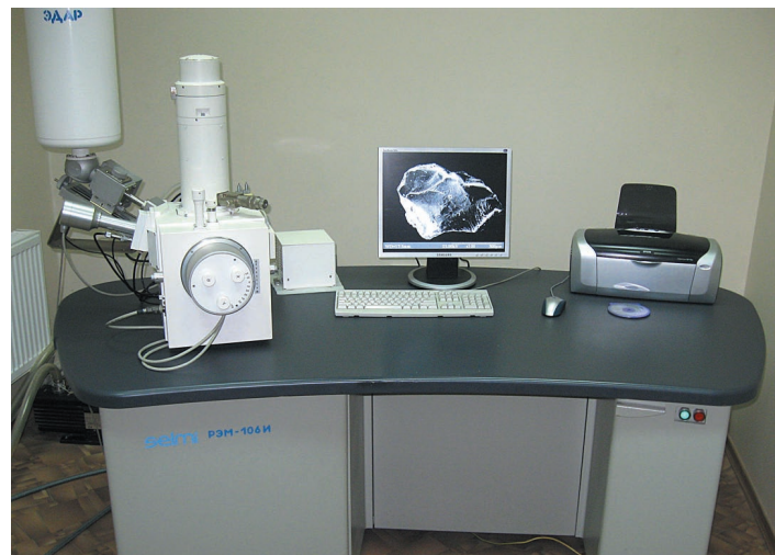
Фото 2. Установка РМ-106И производства фирмы “SELMI” в процессе выполнения исследования трещиноватости зерен граната
