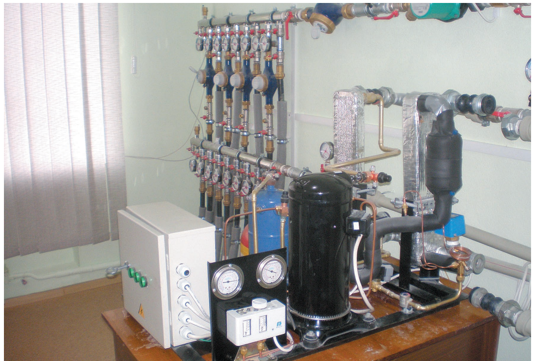
Рис. 2. Наземная часть геотермальной системы закрытого типа УкрГГРИ
