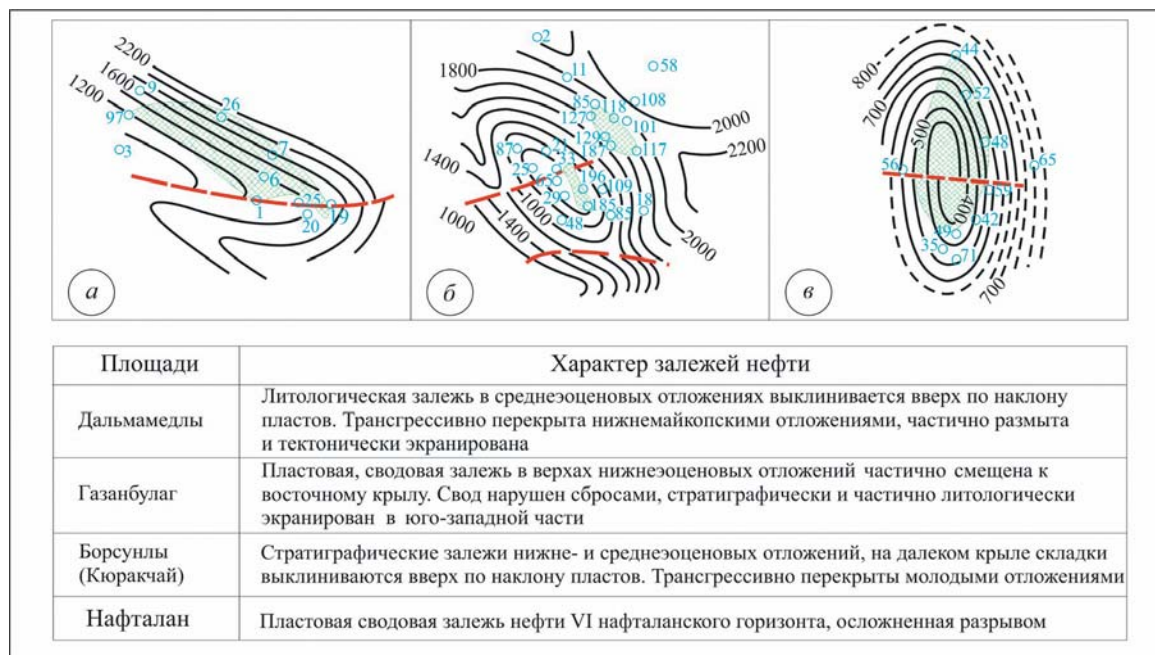
Рис. 5. Гянджинский нефтегазоносный район (северо-западная зона). Схематические структурные карты:
