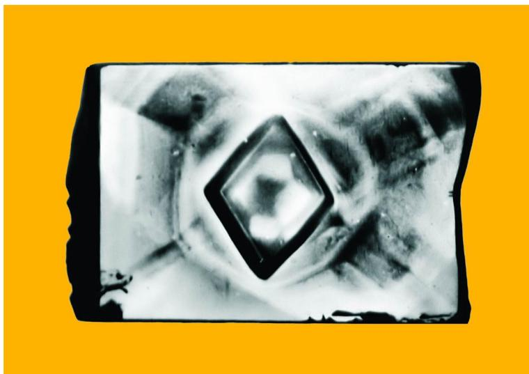
**Рис. 2.** Сложное внутреннее строение (анатомия) кубического кристалла раннего семейства (трубка Удачная). Топограмма пластины по (110) в проходящем монохроматическом УФ-свете с  $\lambda = 300$  нм (черное – поглощение, белое – пропускание). В кристалле наблюдается смена формы: кубооктаэдр  $\rightarrow$  октаэдр  $\rightarrow$  кубооктаэдр  $\rightarrow$  куб
