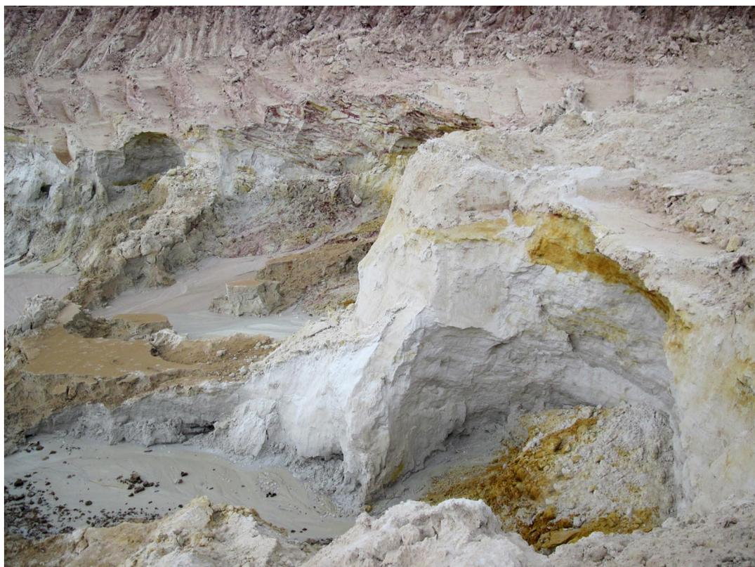
**Фото 5. Размыв песков, залегающих непосредственно над полезным ископаемым, в западной стенке карьера Опытного месторождения**
