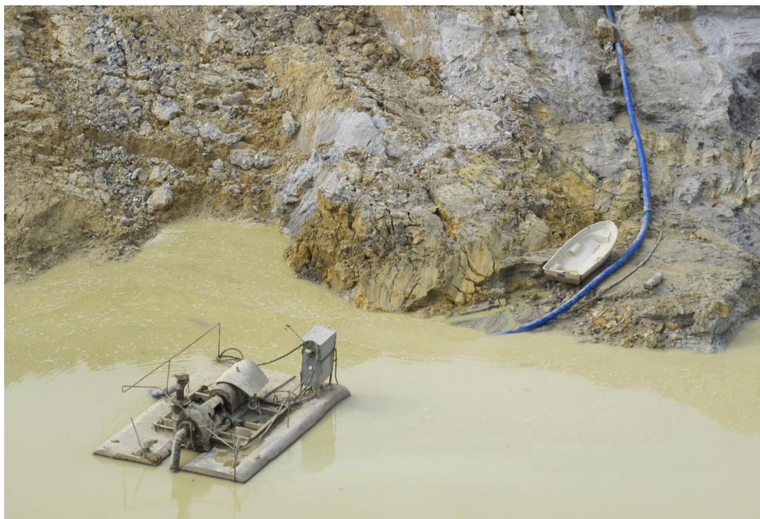
**Рис. 5.** Відстійники для знешламлювання води
