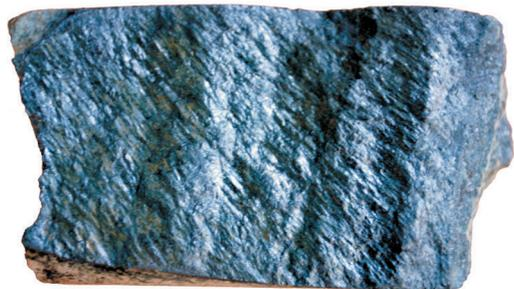
**Фото 2.** Тріщина відколу, “гофрована” поверхня якої складена перетертим тонколукуватим графітом. Сверд. 64, гл. 205,4 м. Діаметр керна 59 мм
