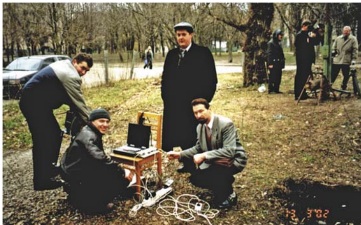
Испытание первой в Украине бескабельной забойной телеметрической системы ПАРКУС (2004 г.)
