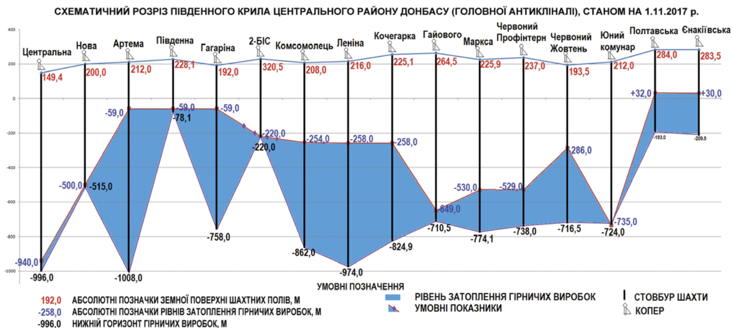
Рис. 2. Схематичний структурно-гідрогеологічний розріз Південного крила Центрального району Донбасу (станом на 1.11.2017 р.)
