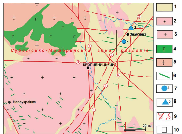
Рис. 2. Геолого-структурна схема розміщення Суботської ділянки (з використанням геолого-формаційної основи Є. М. Лазька та ін., 1991): палеопротерозойські утворення (PR 1 ): 1 – метаморфізовані осадові й вулканогенно-осадові формації (інгуло-інгулецька серія (PR 1ii )); новоукраїнський комплекс (PR 1nu ): 2 – формація чарнокітоїдів, трахітоїдних гранітів; кіровоградський комплекс (PR 1kg ): 3 – формація прогресивних ультраметаморфічних автохтонних і параавтохтонних гранітів; мезопротерозой (PR 2 ): формація анортозит-рапаківі-гранітна (корсунь-новомиргородський комплекс (PR 2kn )): 4 – габро-анортозити, 5 – граніти рапаківі та рапаківіподібні; неопротерозойські утворення (PR 3 ): 6 – дайки діабазу, габро-діабазу та камптоніту; великі рудопрояви урану, що мають чималі концентрації ітрію, рідкісних земель і фіксуються аномальними геохімічними ореолами цих елементів: 7 – Знам’янський рудопрояв урану у фосфорно-рідкісноземельно-торій-ураноносних метасоматитах; 8 – Дмитрівський рудопрояв урану рідкісноземельно-торій-уранової формації в пегматоїдних гранітах; 9 – осьові лінії розломів: а – провідних (цифри в кружечках): 1 – Кіровоградський, 2 – Мар’ївський, 3 – Суботсько-Мошоринський, 4 – Інгуло-Кам’янський; б – другорядних, 10 – контур Суботської ділянки
