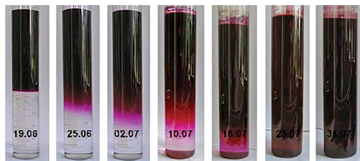
Рис. 3. Візуалізація дифузійно-конвекційного процесу під час моделювання зимових умов (нагрівання згори)
