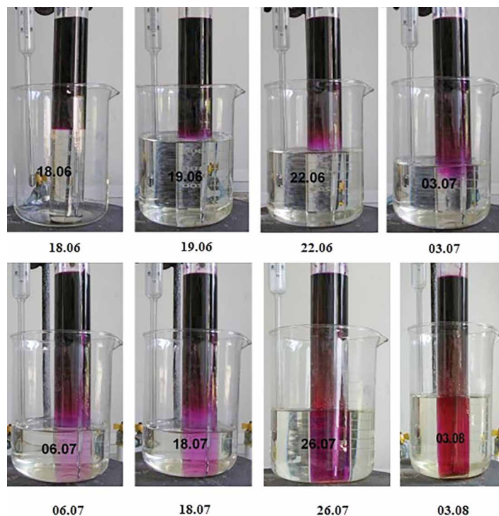
Рис. 2. Візуалізація дифузійно-конвекційного процесу під час моделювання зимових умов (нагрівання знизу)
